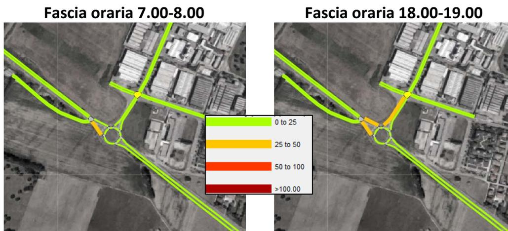
Figura 10– Scenario 0 - Risultanze delle simulazioni microscopiche – Velocità media [km/h]
