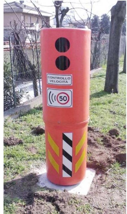
Le colonnine possono fungere da semplice dissuasore oppure, alloggiando al proprio interno in modalità "random" le apparecchiature di rilevazione della velocità, possono fungere da vero e proprio "autovelox".
