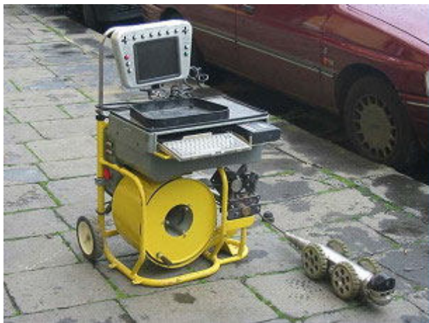
Esempio di apparecchiatura per video ispezioni dei condotti fognari
