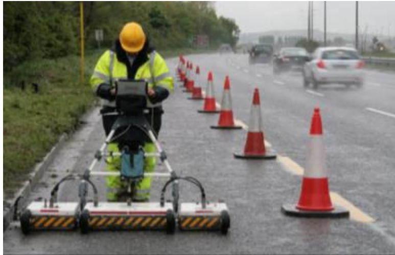
Esempio di rilevamento delle reti nel sottosuolo attraverso georadar
