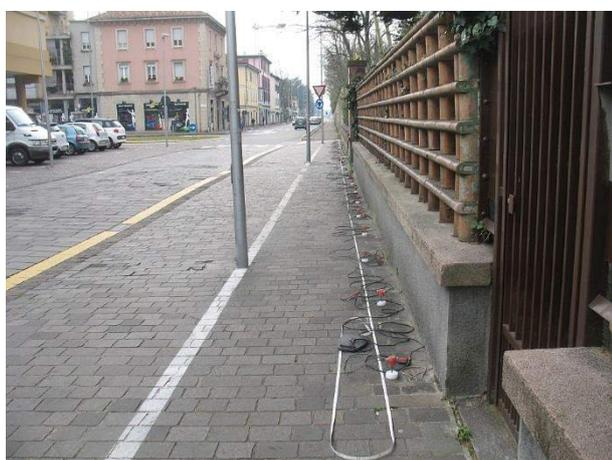
L'acquisizione dei dati per la definizione della Vs30 è stata svolta tramite l'acquisizione e la registrazione del noise ambientale impiegando geofoni da 4.5 Hz ed un acquisitore digitale multicanale a 24 canali con dinamica a 24bit. E' stato acquisito 1 profilo sismico (come da planimetria generale), costituito da un allineamento di 24 geofoni equispaziati di 1.50 m. Per la prova sismica sono stati raccolti oltre 20 records di lunghezza di 30 sec. con campionamento ogni 2ms.
